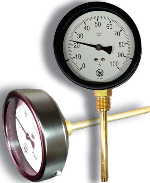
Termômetros bimetálicos, construídos com caixa em aço carbono, internos, haste e soquete em latão são indicados para medições de temperaturas em processo. A escala de medição deve ser determinada conforme sua necessidade, podendo chegar até 500°C. Para temperaturas superiores, consulte nossa equipe de vendas.
