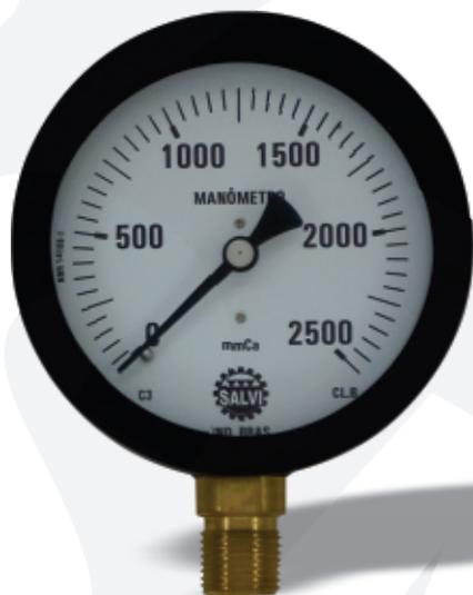
Manômetros Standard com sistema capsular, construídos com caixa em aço carbono, ou em aço inox, e internos e soquete em latão são indicados para medições de baixa pressão (abaixo de 1 BAR).
